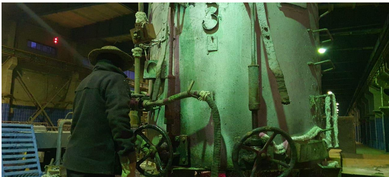
Рисунок 6 – Выборка металла (магния-восстановителя) вакуум-ковшом
