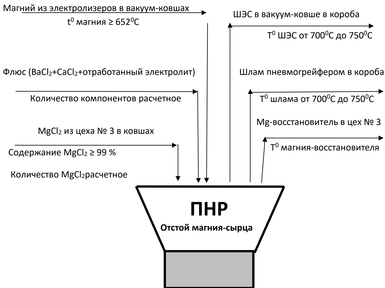
Рисунок 10 – Аппаратурно-технологическая схема производства магния-восстановителя
